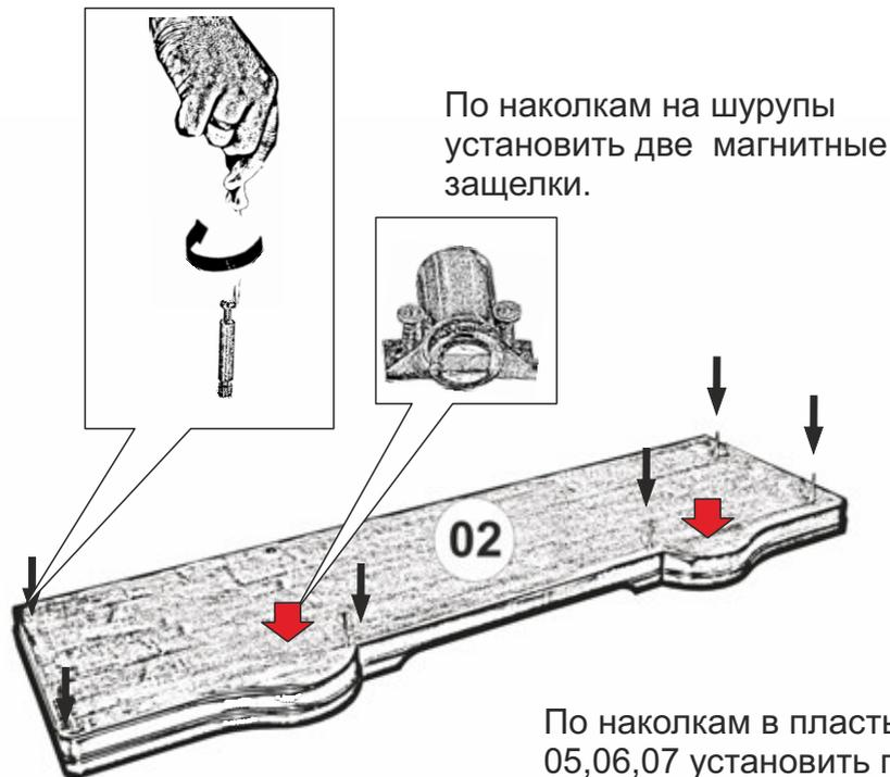
По наколкам в пластъ колонок 05,06,07 установить по одному ввинчиваемому дюбелю.
