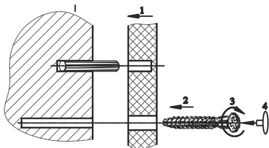
Монтаж деталей с помощью эксцентриковой стяжки.
