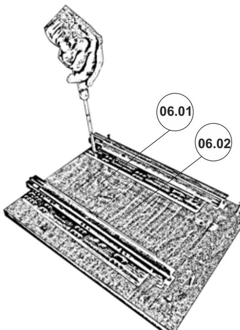
Вертикальные стенки тумбы 06.01 и 06.02 оборудовать направляющими, как показано на рисунке. Совместить 2 и 11 отверстия на механизме с отверстиями на стенках вертикальных. Вставить винты 6,3x10 в отверстия и завернуть их по часовой стрелке до упора.
