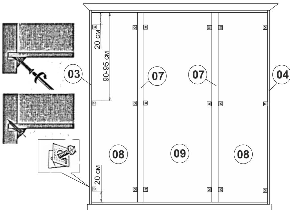
Сверху и снизу по длинным сторонам задних стенок отмерить по 20 и 90 см. По отметкам установить соединители с каждой стороны задней стенки на шурупы при помощи отвертки, обеспечив плотное прилегание фурнитуры и деталей:
