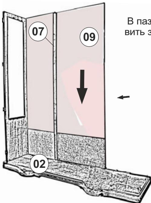
В паз цоколя 02 и колонки 07 установить заднюю стенку с зеркалом 09.
