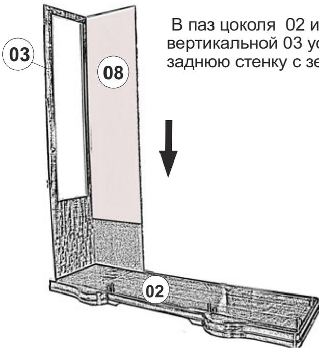
В паз цоколя 02 и стенки вертикальной 03 установить заднюю стенку с зеркалом 08 .
