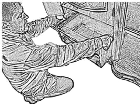
В проем под дверь вставить каркас тумбы. Совместить отверстия на планках тумбы с установленными в цоколе гайками. Крепить каркас тумбы винтами с плоской головкой и шестигранным гнездом на 2-3 оборота.
