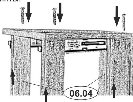
Поставить собранную конструкцию на стенку вертикальную 06.01. Сверху на шканты установить стенку вертикальную 06.02 и зафиксировать ее на евровинты.
