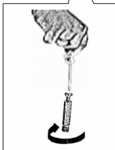
Установить 6 соединительных винтов на карниз 31 и зафиксировать их при помощи отвертки по часовой стрелке до упора.
