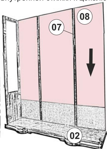
В паз цоколя 02 и колонки 07 установить заднюю стенку с зеркалом 08.
