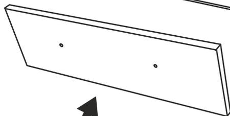
В отверстия на панели боковых стенок ящиков установить эксцентрики на 16 мм.
