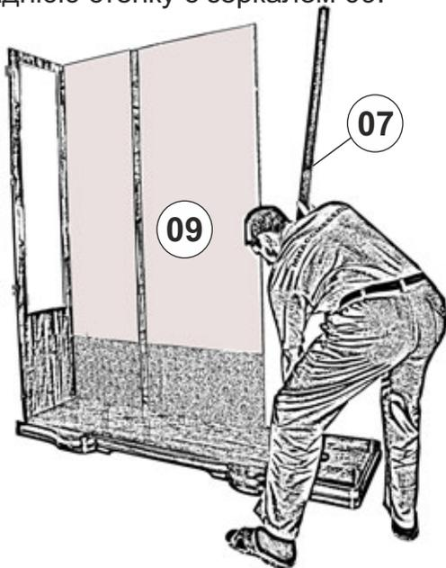
Установить колонку 07 пазом к задней стенке 09 и закрепить ее при помощи внутренней стяжки к цоколю 02.
