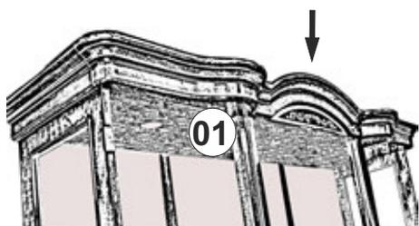
Установку карниза 01 производить вдвоем во избежание падения и поломки деталей изделия. Установить карниз 01 соединительными винтами на собранную конструкцию, вставив заднюю стенку в паз. Зафиксировать эксцентрики.
