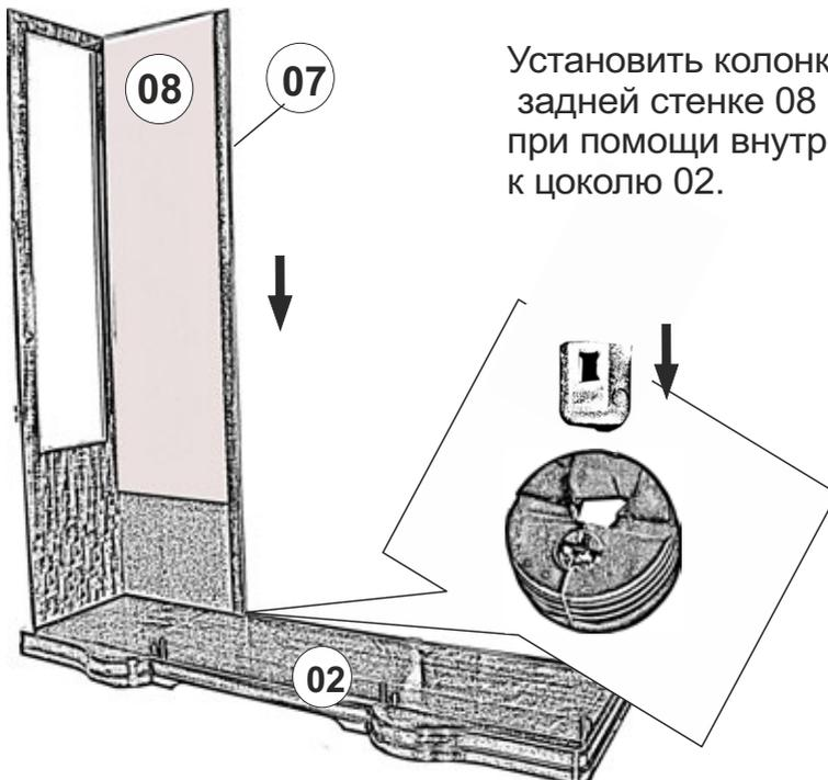
Установить колонку 07 пазом к задней стенке 08 и закрепить ее при помощи внутренней стяжки к цоколю 02.
